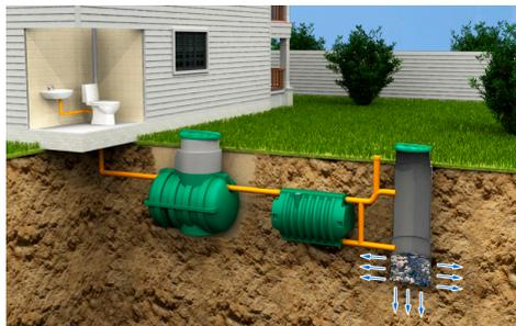
Сброс очищенной воды самотеком в придорожные канавы, при использовании в зимнее время года, может привести к намерзанию льда в отводящем трубопроводе и блокированию выхода чистой воды. Для использования АК Rostok в зимнее время года рекомендуется установка накопительного колодца и дренажного насоса для принудительного отведения очищенных стоков.
